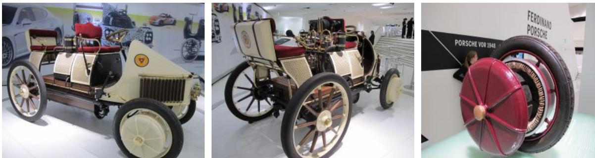
Jacob Lohner, Wien, hat Elektromotoren in den vorderen Radnaben...Replika
