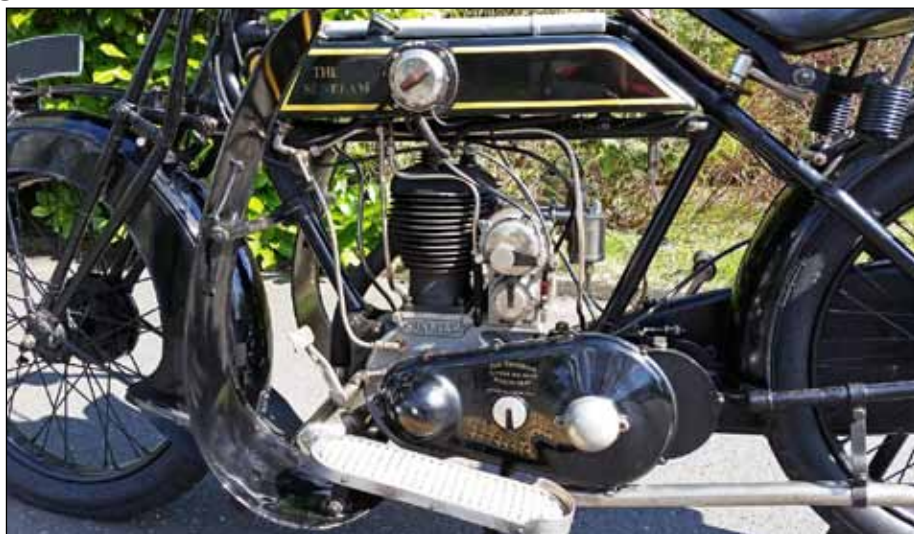
Macht schon was her: Der 600-ccm-Einzylindermotor der Sunbeam Modell 7.
