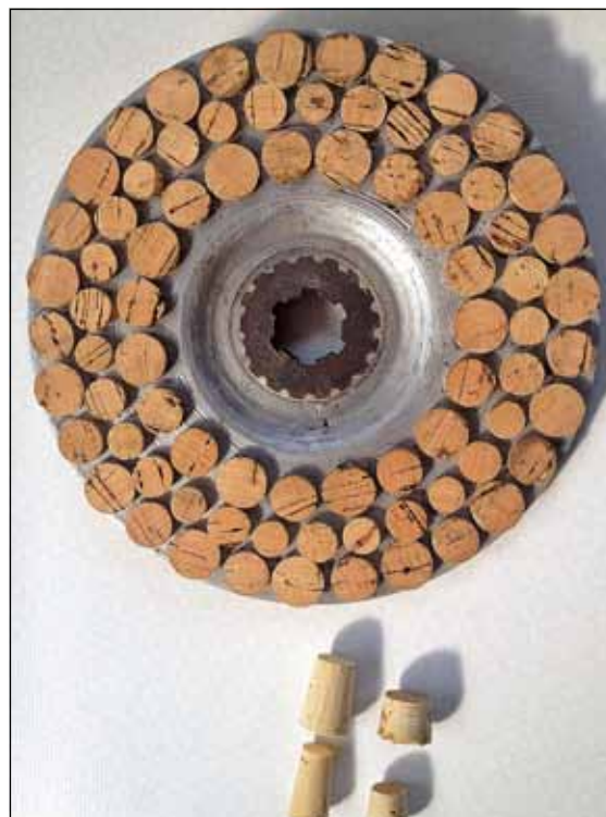
Einfache aber wirkungsvolle Lösung: Die Kupplung an Holger Achelpohls Zündapp ist mit Kork belegt.
